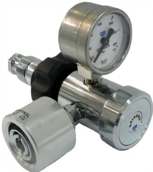
O redutor de pressão **Redflow** é uma válvula redutora de pressão para o uso em garrafas de alta pressão de Oxigênio e de Ar Medicinal, obtendo uma pressão fixa e constante de saída de 3,5 Kg/cm<sup>2</sup>.
