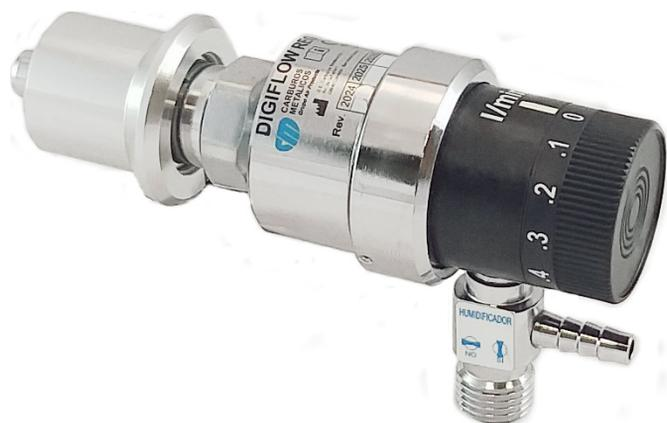
O regulador de caudal **Digiflow Reg** é uma válvula reguladora de caudal de baixa pressão e com um estabilizador de pressão incorporado na entrada, que se liga às tomadas de gás através de um conector seletivo mediante uma mangueira de 1,5 m de comprimento sobre um grampo em rail.
