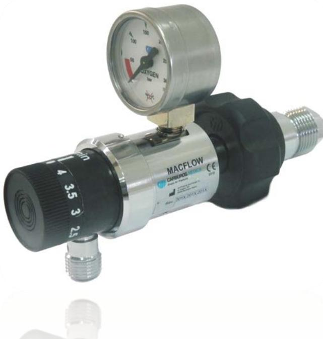
O regulador de caudal **Macflow** é uma válvula reguladora de caudal para uso em garrafas de alta pressão de Oxigénio e de Ar Medicinal, obtendo uma pressão fixa e constante de saída de 3,5 Kg/cm<sup>2</sup>.
